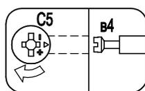
ориентация стяжки С5 - показана на рис, после сборки с дюбелем В4 стяжку затянуть по стрелке
